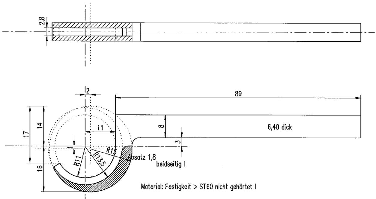
Toleranzen: R11 +0,1/+0,5mm // R13,5 & R15 +/- 0,1mm // Dicke und Absätze +/-0,05mm // übrige Masse +/-0,1mm
