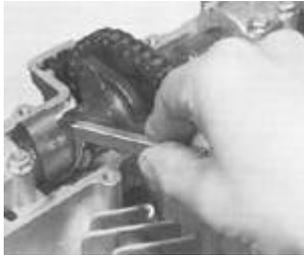
Um bei GS-Motoren zum Einstellen des Ventilspiels einen anderen Shim zu montieren, muss zunächst der Tassenstößel nach unten gedrückt werden, damit man den vorhandenen Shim entfernen kann. Das geschieht durch das gezeigte Niederhalter-Spezialwerkzeug, welches man bei SUZUKI oder im Zubehörhandel kaufen kann. Zur Not tut es auch ein Schraubendreher, aber die Gefahr die Nocken zu beschädigen, ist relativ groß.
